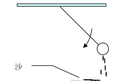
**檢查點五：**單擺長度  $L$  懸挂于升降機的天花上。升降機靜止時，單擺周期為  $T$ 。下列單擺周期將如何改變 (a) 升降機以勻速度向上移動 (b) 升降機以勻加速度向下移動。
