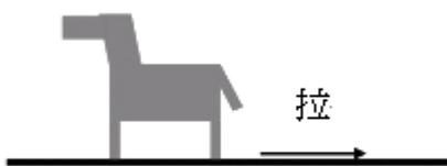
一玩具木馬，質量為 100 克，重心在離前腿 0.05 m，離地 0.05 m 處，前後腿距離為 0.15 m，放在平桌面的桌布上，前腿離桌布邊 0.3 m。布與木馬間的磨擦係數為  $\mu = 0.75$ 。現突然將桌布以相對於桌面  $9.0 \text{ m/s}^2$  的加速度拉走。求
