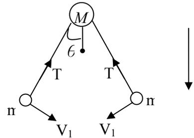
下面在随M一起运动的坐标系中求小球M受到的力 $f$
